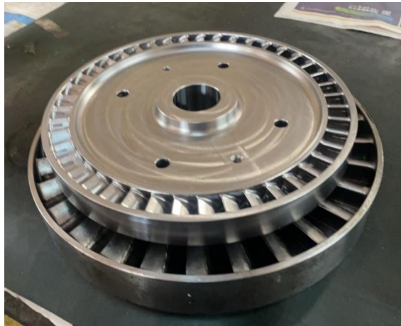
軸流渦輪(靜子+轉子)：5軸加工
