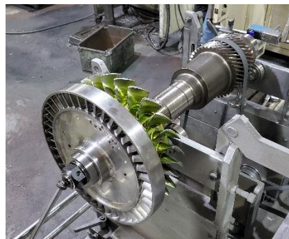
軸流渦輪(5軸加工)+齒輪組
